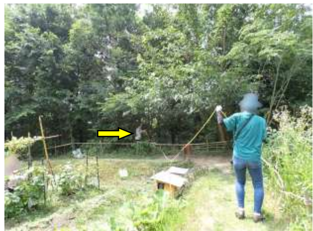
毎木調査：測定対象(矢印)から 15m 程度離れた位置で スラントレベルを使って仰角を測る(樹高 10m 程度の樹木)
