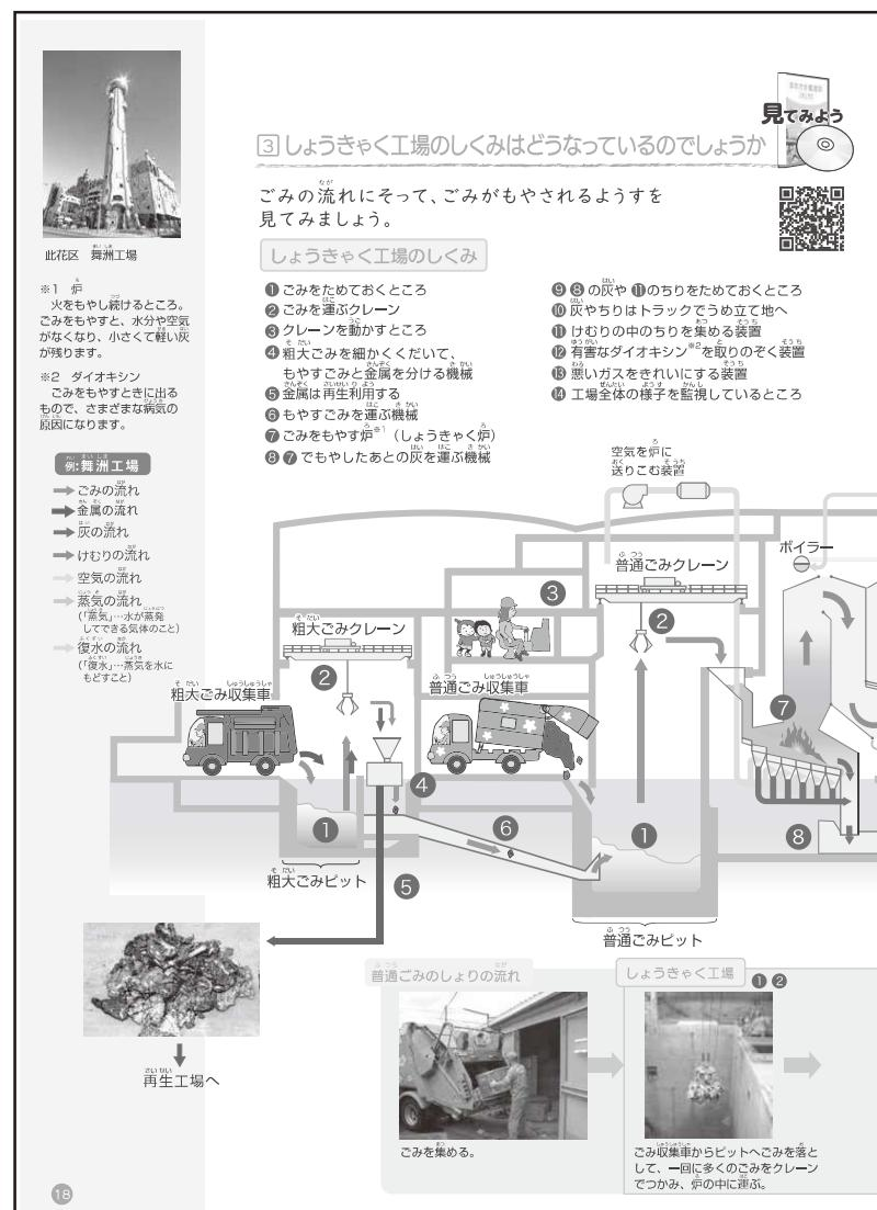
粗大ごみは破碎施設で粉々に砕き、ごみに含まれる金属(鉄・アルミ)を回収・再資源化を図ったのち、残ったものは焼却している。
