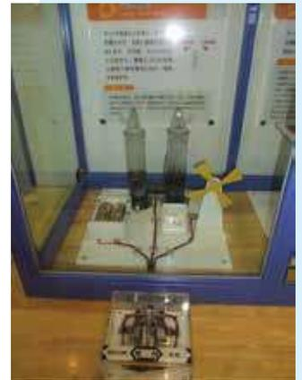
燃料電池と同じしくみで発電する装置
