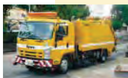
ブラシを回しながらごみをすいこんで道路をそうじする「路面清掃車」
