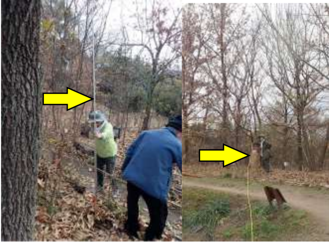
毎木調査：樹高が5 m程度ならばジャーマンメジャー それを超えると三角法で離れたところから仰角を測る
