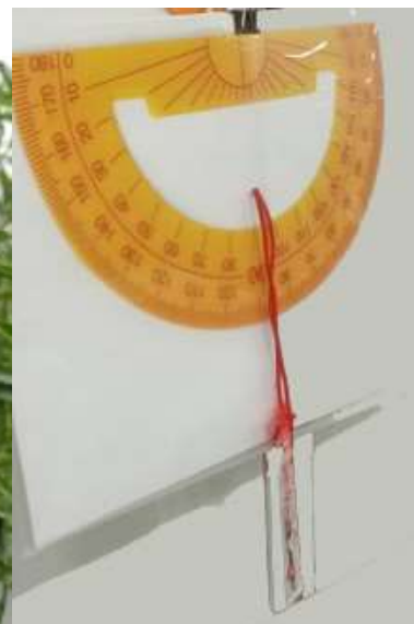
観察園全樹木調査用に、NTTさんが試作された樹木ラベルと、樹高測定用分度器 樹木に固定するための紐の検討が必要
