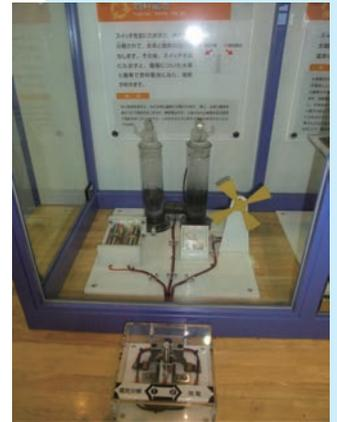
燃料電池と同じしくみで発電する装置
