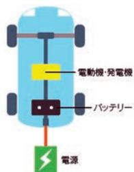
例えば、バッテリーに充電した電気でモーターを動かして走る電気自動車 (EV) や、水素と空気中の酸素を反応させて作った電気で走る燃料電池自動車 (FCV) は、走る時に二酸化炭素を出しません。
