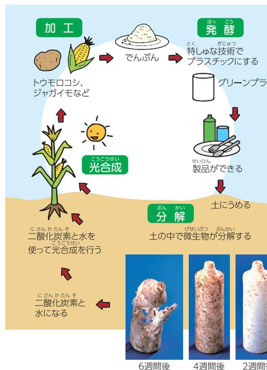
ふつうのプラスチックと同じように使うことができ、使った後は土にうめると、微生物の働きによって二酸化炭素と水に分解されます。二酸化炭素と水は光合成を行うときに、植物に吸収されます。
