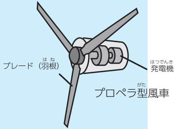
羽根自体が羽根車(タービン)の役割をしており、風の強さや向きによって羽根の角度や向きを変えることで効率よく運転できます。
