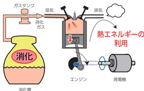
エンジンを使った発電(消化ガス発電)
