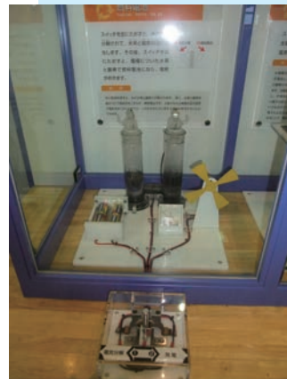
燃料電池と同じしくみで発電する装置
