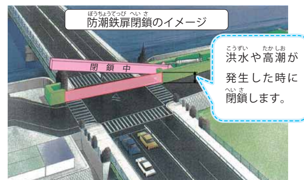
よどがわ 淀川大橋の防潮鉄扉
