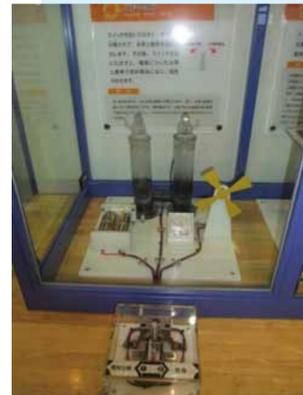
燃料電池と同じくみで発電する装置
