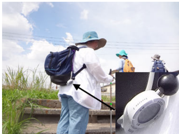
暑さ測定器:熱中症を予防するために、測定器の基準 値を超えると警戒音が鳴ります。暑くなるほど警戒音 は激しくなり、この日もよく鳴っていました。調査に夢中 になり、このような音を聞かなかつたら、休む気配りも 忘れてしまいますので、夏場には便利な機器です。
